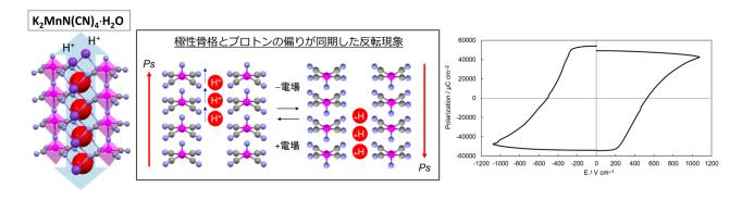
(参考図) 新たに合成した「強誘電イオン伝導体」の構造と分極反転メカニズム。および、強誘電ヒステリシス。
