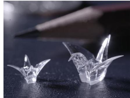
↑ 小指の上の微小サイズの鶴。加工が難しく単純な形状しか作製できなかった石英ガラスを、3Dプリンタにより超複雑形状で作製する技術を開発！
