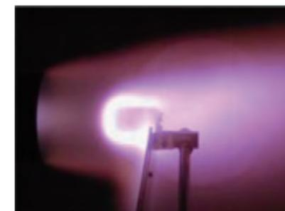
アーク加熱風洞による耐熱試験
