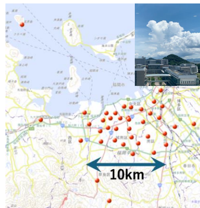
図 4：福岡市実証実験フルサポート事業で設置する観測点。積乱雲（大きさ 1~10km）にともなう気圧の変動を詳しく観測できます。
