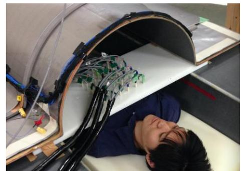
図. 36 チャンネル FM-OFG アレイと上下分離型能動磁気シールド。シールド上側は被験者の足側にスライドした状態。
