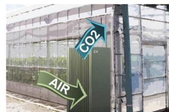
◀DAC-U®システムの活用により、エアフィルターのように大気からCO<sub>2</sub>を回収・濃縮し、農業用ハウスなどの施設に設置した装置で施用することで、作物の収穫量の増加、脱炭素化に貢献可能
