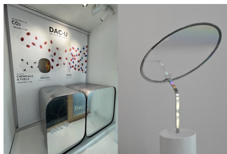
左写真： DAC-U 装置（左）と CO 2 を捕捉するナノ 膜（右）
