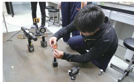
レーザーを用いた光の干渉実験
