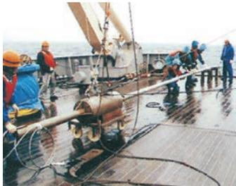
ペーリング海の海底堆積物を全長15mのピストンコアにより採取、過去から現在までの地球環境変動を明らかにする。
