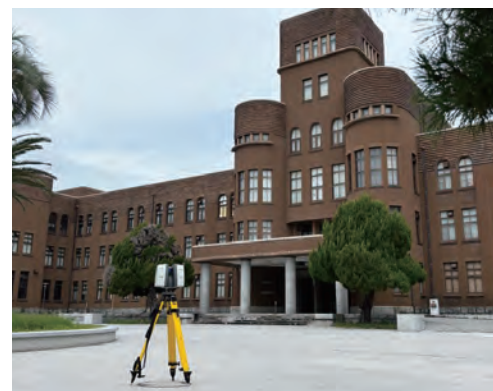
①外壁部分のレーザースキヤニング風景
