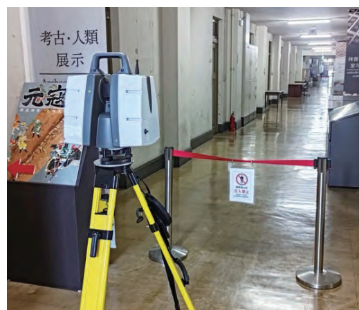
②2階廊下部分のレーザースキヤニング風景
