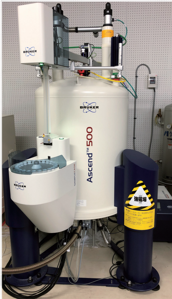
有機化合物の構造決定に用いられる核磁気共鳴装置
