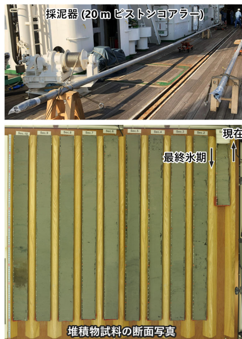
図3 本研究で使した堆積物試料の採取に用いた採泥器 (20 m ピストンコアラー) と試料の断面写真
