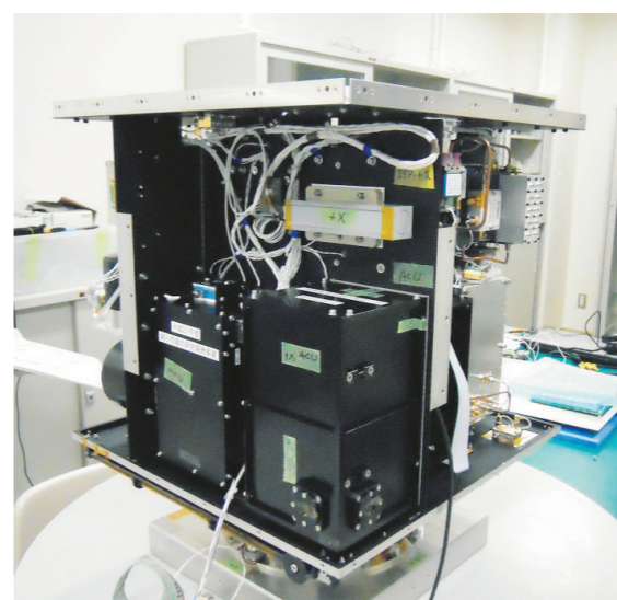
九州大学で開発した超小型衛星QSAT-EOS (1辺50cm、50kg)
