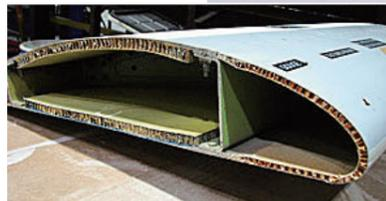
飛行機の翼の断面。サンドイッチ構造の具体例。
